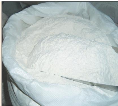
ков перед золой уноса определяется тем, что получаемый из них продукт лучше других обволакивается битумом и в зоне контакта образует водонерастворимые соединения, которые придают дополнительную прочность, водо- и теплостойкость асфальтобетону. А эти свойства тем более необходимы в нашем суровом сибирском климате.
