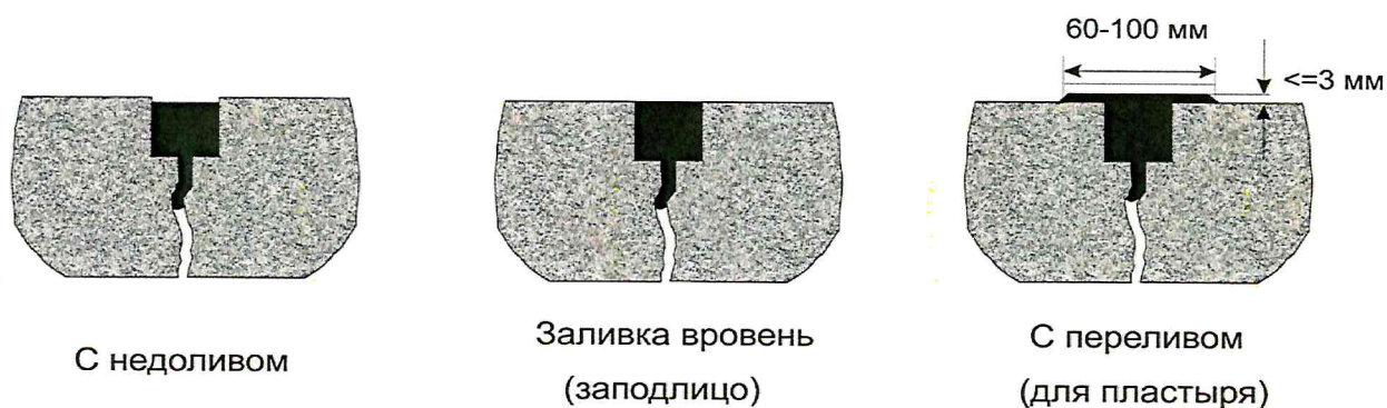
Рисунок 6.1 – Варианты заливки герметика в трещины
