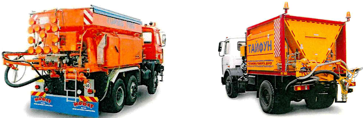
Рисунок 3.1 Комплект оборудования по устранению повреждений покрытия струйно-инъекционным методом
